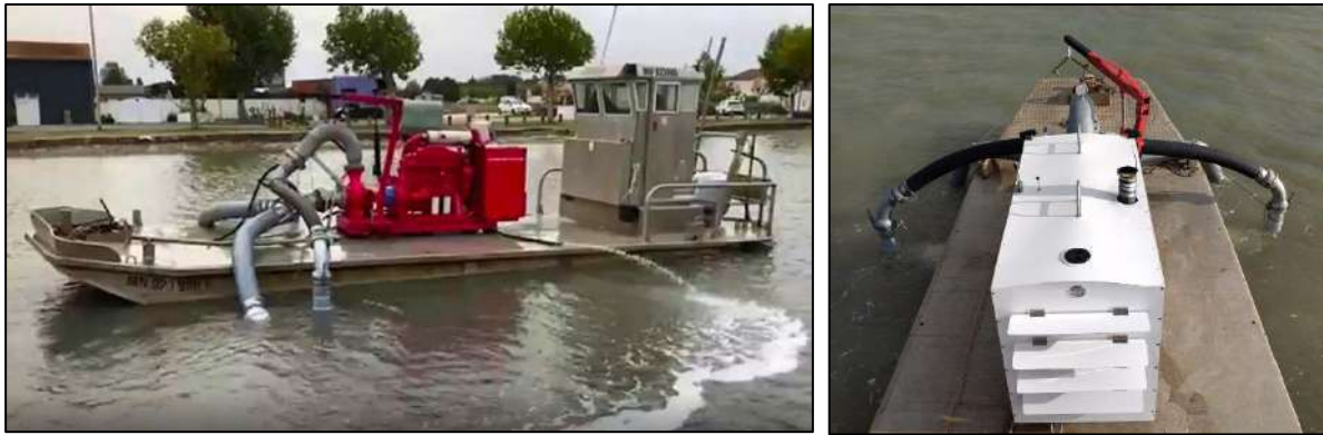
Figure 17 : Photographies d'une hydrodévaseuse adaptée aux travaux sur le domaine public fluvial du bassin de la Maine
