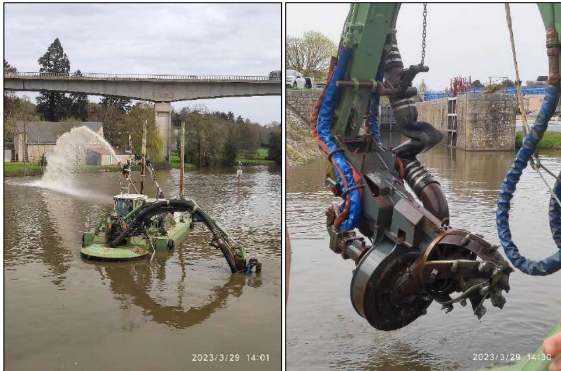
Figure 16 : Photo d'une drague aspiratrice (à gauche) et d'un désagrégateur sur bec d'élinde (à droite)
